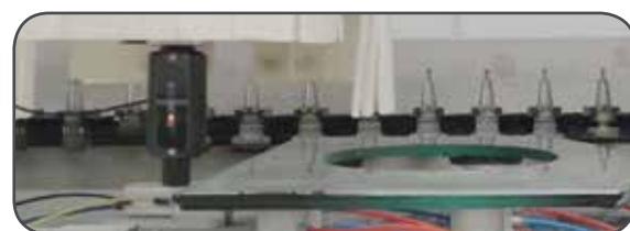
2D Optical Sensor For template scanning and piece origin detection Sensore Ottico 2D Per la scansione della sagoma e l'individuazione dell'origine del pezzo
